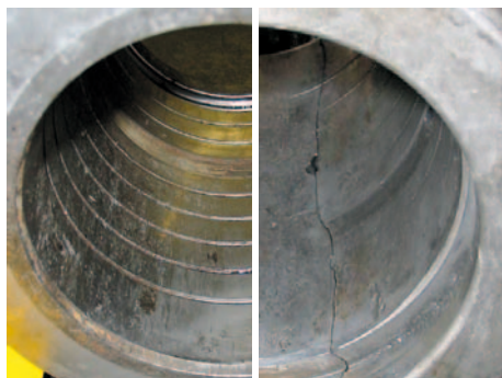
Pasta pre hydraulické kladivá Cat® vytvára ochrannú vrstvu medzi nástrojom a puzdrom.
